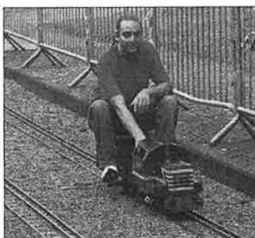
Locotracteur n°7332 de la SNCB (5 pouces) à moteur thermique (moteur de tondeuse).
